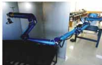
图(b) 展开后的蛇形机器人
