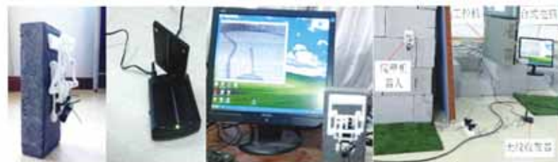
实验室环境下获取垂直转面的裂缝。从左到右: 机器人实物图; 无线收发器; 摄像头测试; 实验室环境下获取裂缝。
