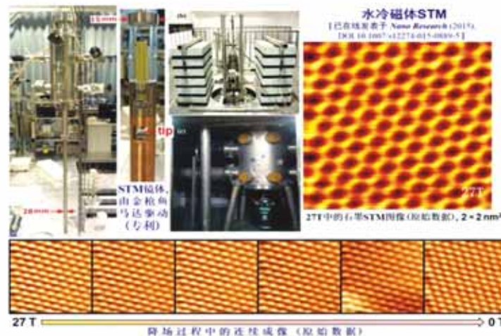
左上图: 首个水冷磁体原子分辨率扫描隧道显微镜 (STM) 的实物照片; 中心图: 强磁场科学中心编号为 WM4 的水冷磁体; 右上: 在 WM4 中测得的 27 T 强磁场中的石墨 STM 原子分辨率图像; 下图: 在 WM4 中测得的变场条件下的石墨 STM 原子分辨率图像系列。
