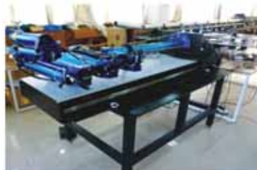
图(a) 处于折叠收拢状态的蛇形机器人
